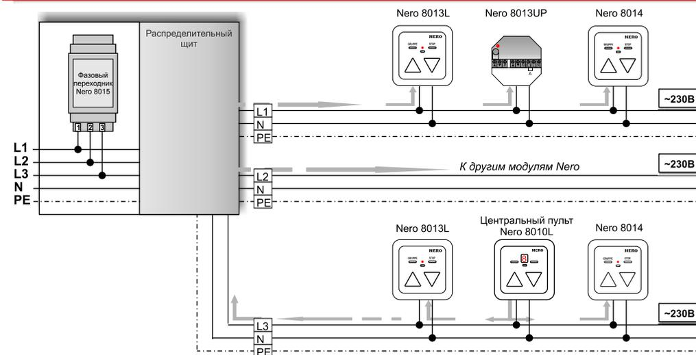
После монтажа фазового переходника в электрораспределительный щит обеспечивается надежная связь между всеми модулями системы, например, между несколькими исполнительными устройствами Nero, объединенными в одну группу управления, но подключенными к разным «фазам» сети 230В.
